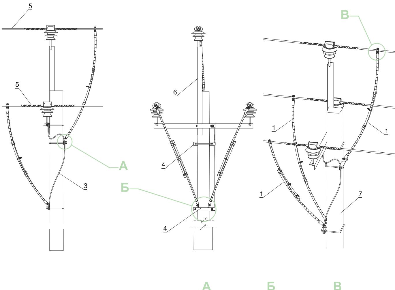
Рис.6. Вариант установки разрядника на ВЛ
